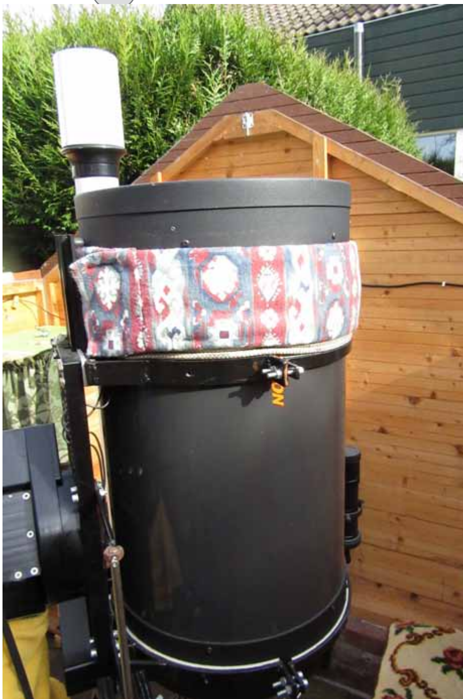
Rondom het bovenste deel van de telescoopbuis, net onder het objectief of correctorplaat, zit de verwarmde deken. Op het bovenste deel komt nog een kunststof dauwkap, die staat niet op de foto.
