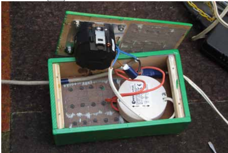
Links, het zwarte toestel, is de dimmer, en rechts, het witte, is de trafo. In het doosje zitten wel gaten voor de koeling, maar eigenlijk komt er nauwelijks warmte vrij.
